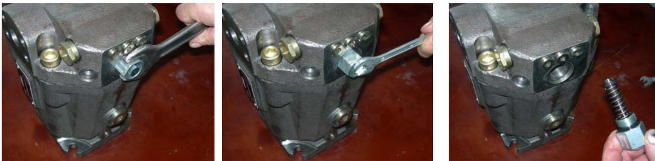
Рекомендуется до демонтажа клапана подпитки пометить маркером положение контргайки относительно задней крышки и относительно корпуса клапана. В случае если не потребуется замена клапана подпитки установить клапан согласно метки и провести настройку давления.
