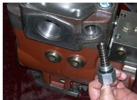
Рекомендуется до демонтажа клапана подпитки пометить маркером положение контргайки относительно задней крышки насоса и относительно корпуса клапана. В случае если не потребуется замена клапана подпитки установить клапан согласно метки и провести настройку давления.
